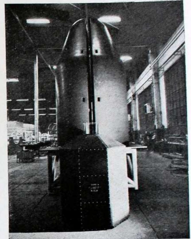
El escudo protector térmico del vehículo lanzador ELDO, construido por FIAT, en cuyo interior irá alojado el satélite artificial europeo (en primer plano), con sus antenas de telemetría. Abajo: simulador empleado en las pruebas de resistencia a las altas temperaturas del escudo térmico del ELDO.
